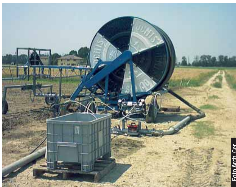
Foto 1 Attrezzatura per la fertirrigazione con il rotolone.
